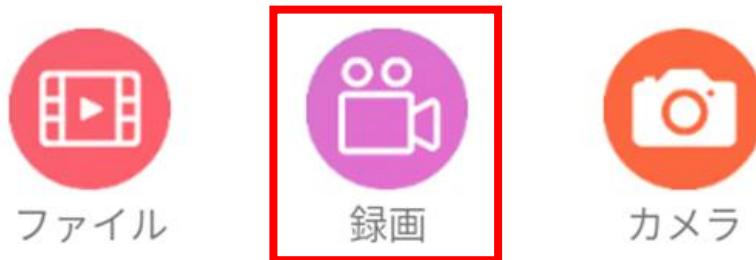
「自動録画」のスイッチボタンをONにして保存をタップします。SDカードへ自動で録画録音が開始されます。なお、この設定はデバイスを再起動しても自動的に録画が開始されます。
